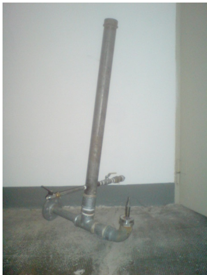
Abb. 2: Hydraulischer Widder des Fachgebiet Hydromechanik, TUM
