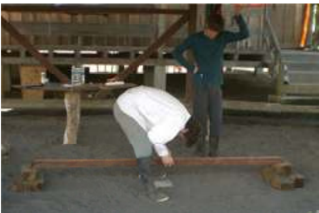
Abbildung 8: Durchführung des Biegeversuchs
